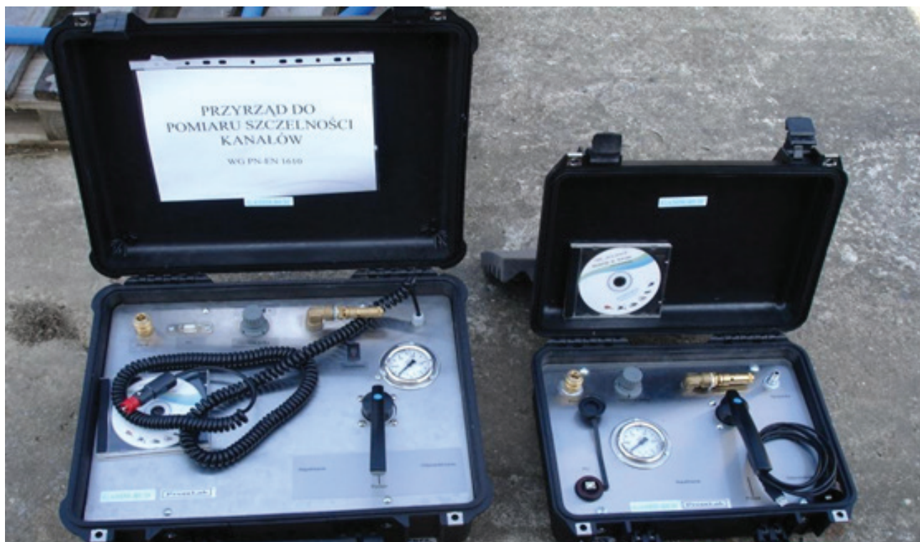
Fot.4. Przykładowe rozwiązania przyrządów (komputerów) do pomiaru szczelności.
